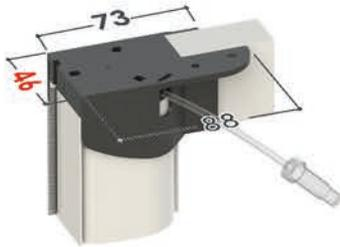
**Attenzione:** per l'installazione considerare che la testata superiore misura 46 mm in profondità, mentre la testata inferiore misura 42 mm
